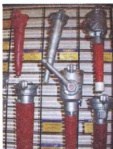
*Пожарные стволы* предназначены для получения сплошных или распыленных водяных и порошковых струй. Они разделяются на ручные и лафетные. *Ручные стволы* служат для создания компактных водяных струй, широко применяются в народном хозяйстве.
