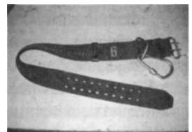
Карабин служит для торможения спасательной веревки при спасании и самоспасании, для закрепления за конструкции.
